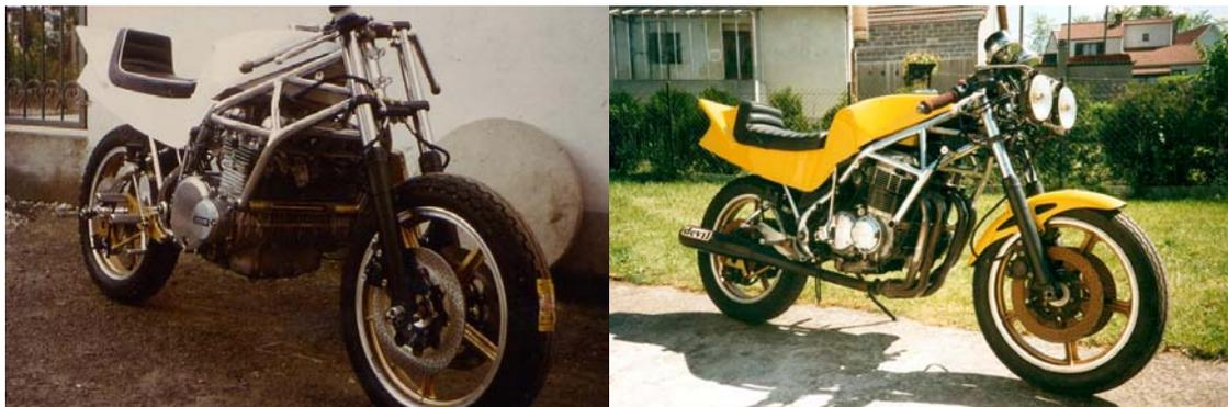
**Zwei Beispiele für den Gitterrohrrahmen mit Cantilever Federung und Schwinge aus Rundrohr (*cadre périmétrique avec la suspension cantilever*)**
