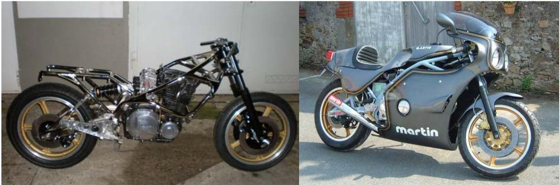
***MARTIN Gitterrohrrahmen (Structure latérale 1re version) als nackter Rahmen, rollendes Fahrgestell und fertige Maschine in Komplettausstattung.
